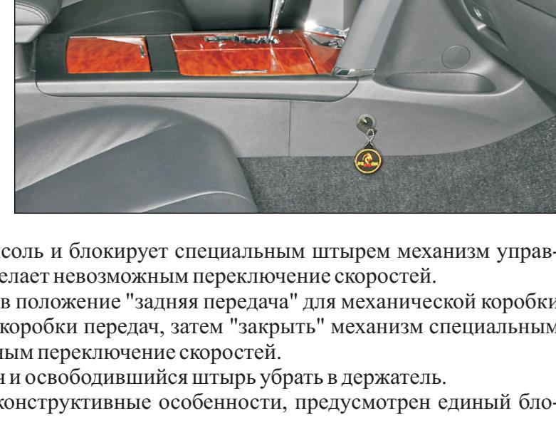
**Штыревой блокиратор КП:** устанавливается под консоль и блокирует специальным штырем механизм управления коробкой передач. При попытке угона **DRAGON** делает невозможным переключение скоростей.
